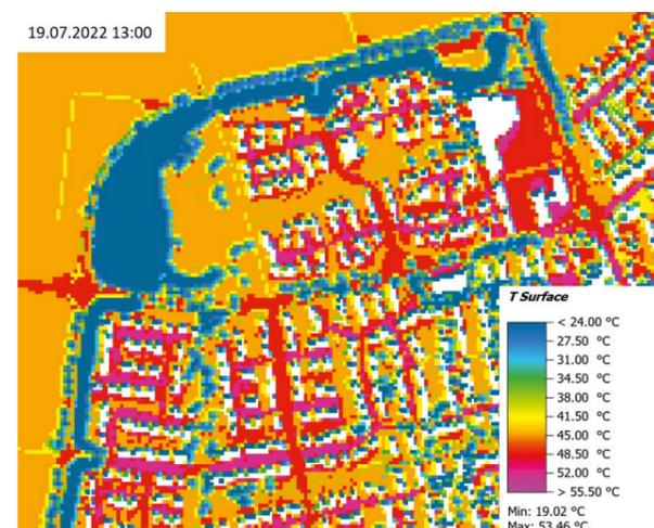
Berechnung der Bodentemperatur in Bodenhöhe – (Worst-Case-Szenario)
